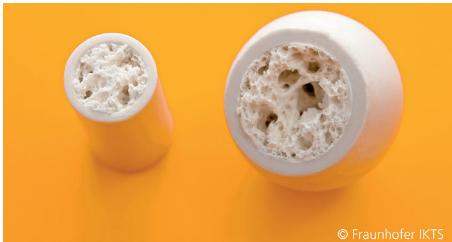
Außen gedruckt, innen geschäumt – keramischer Knochenersatz
